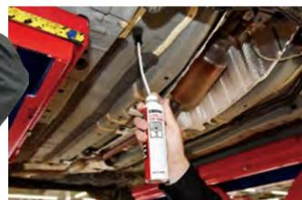
泡状の液剤が「エバポレーター」に浸透し汚れを落としていきます
