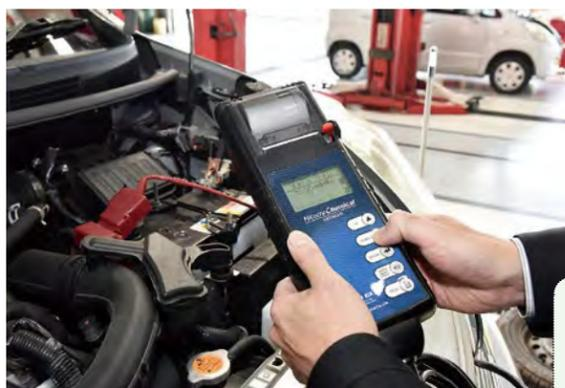
テスターで電圧を計測し、バッテリー液の液量と比重をチェックします
