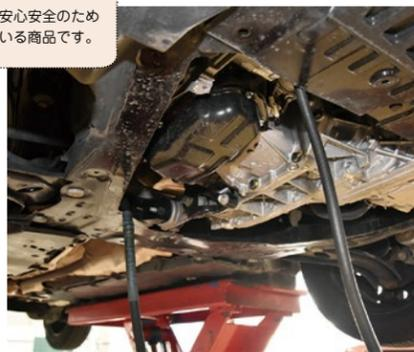
「スラッジナイザー」は洗浄剤をポンプで循環させ、風呂釜掃除のようにフィルターでろ過する洗浄システム
