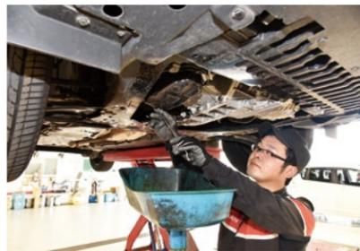
エンジンオイルは、車に使用されている潤滑油。洗浄、防錆、冷却などエンジンを動かす上で重要な役割を果たしています。オイルがなければエンジンは焼き付いてオーバーヒートを起こしてしまいます。また、激しい汚れや蒸発などでオイルが減少すると、エンジンの性能が低下し、燃費の悪化や、最悪エンジンの破損につながります。
