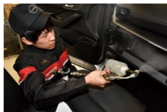
エアコン吸い込み口から吸いこませて、エアコン内部の施工も可能
