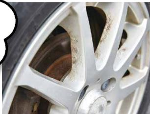
塩害の影響を受けると床下だけでなく、ホイールのサビの進行も早まります。見た目が悪いのはもちろん、さびることによって、側面からのエア漏れ(パンク)の原因にもなります。サビの進行を抑えることができる「塩害対策アルミホイール」があるので、スタッドレスタイヤとセットでの購入をおすすめします。
