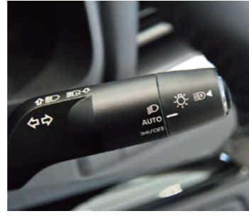
近年の日産車には自動でライトが点灯するオートライト機能が付いているので消し忘れ防止に
