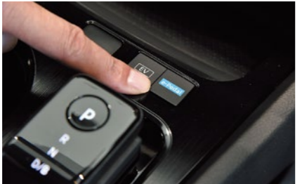
e-Pedalオンの時は減速&停止もアクセルペダルだけでOK。急ブレーキになりません
