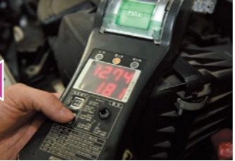
専用の機械を使用しバッテリーチェックをします
