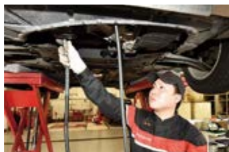
洗浄剤をポンプで循環させ、エンジンを洗うスラッジナイザー
