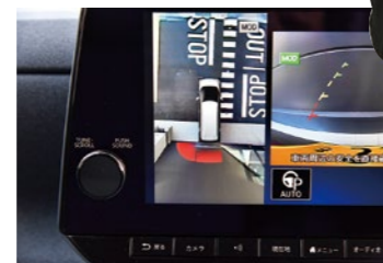
壁などの障害物が近づくと注意信号が黄色→赤色と変わっていき、ぶつかる前に自動停止します
