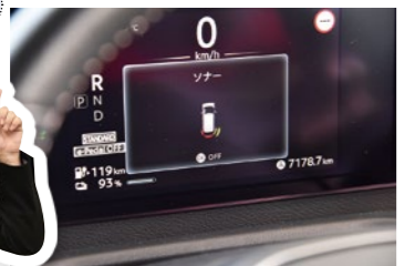
ソナーが反応して画像だけでなく音でも危険を知らせてくれます
