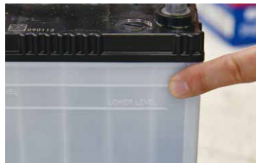
点検時にはバッテリーの液量が下がっていないかもチェックします
