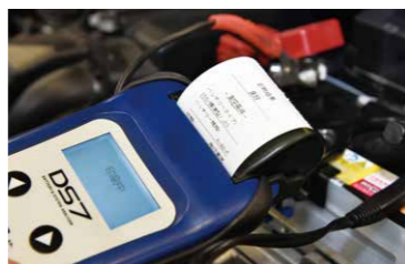
専用の機械を使用しバッテリーチェック。プリンターで検査結果が出ます
