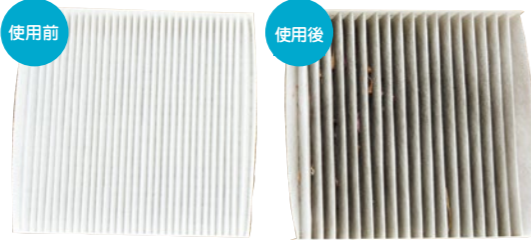
左が新品のフィルター、右が1年使用したフィルター。汚れの違いは一目瞭然です
