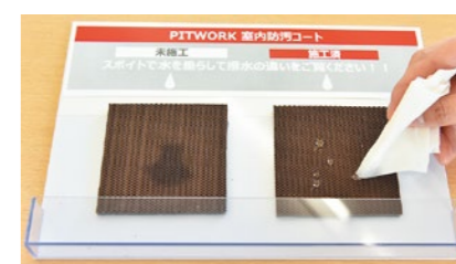
室内防汚コート施工前(左)、施工後(右)。施工したものは水はじきが目瞭然で、拭き取りも簡単
