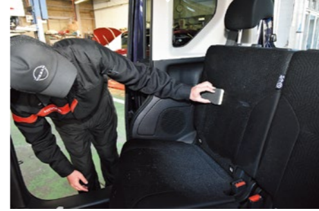
液剤をスプレーし、シート全体にスポンジで塗り伸ばし施工します
