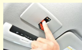
スイッチはフロント上部の天井に。運転席から助手席からも押しやすい
