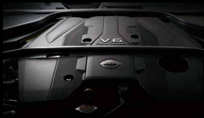
Photo: 3.0L VR30DDTT Twin Turbo V6 Engine 最高出力: 298kW (405PS) / 6400rpm 最大トルク: 475N・m (48.4kgf・m) / 1600-5600rpm
