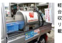
軽トラックの荷台にすっぽり収まるミニローリーのタンクを載せ配達します
