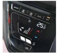
エアコンなどがすべて平面のタッチパネル方式でとても操作がしやすいです
