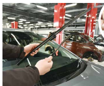
ゴムの劣化であればブレードの交換は不要。ゴムだけをブレードから外して交換します
