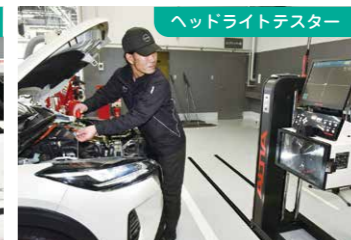
レーザー照準器でランプの中心を正確に正対させるヘッドライトテスター
