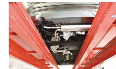
大型のリフトは2メートル以上アップできます。車の真下に入って床下の全体を見渡すことができます
