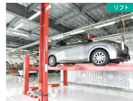
最大4500kgの車を載せることができる大型のリフトも完備
