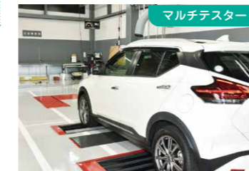
スピードメーターやブレーキ、サイドスリップなどの検査ができるマルチテスター
